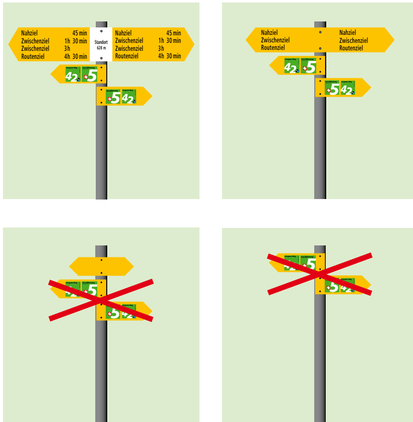
Abb. 18 Montagehinweise für Wegweiser mit Routenfeldern.
